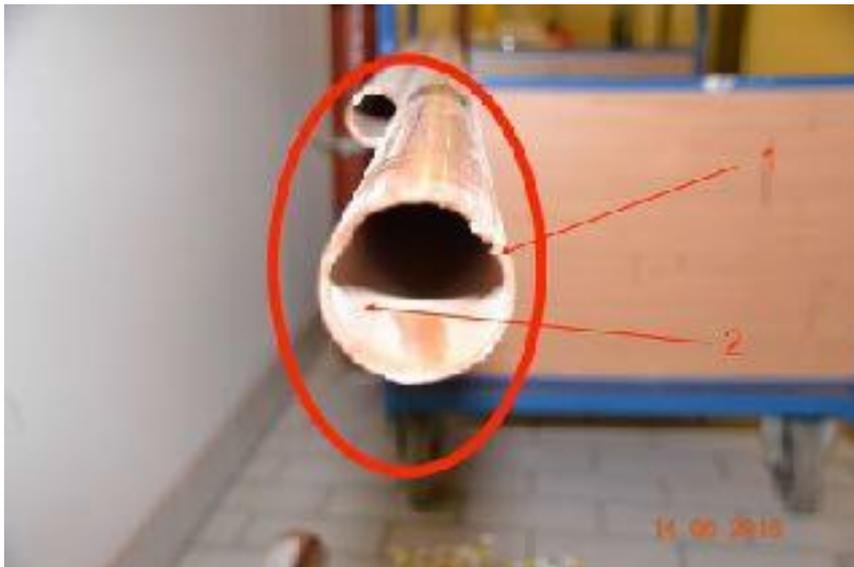
Bild 12: Kupferrohr; Trinkwasserhygiene:
