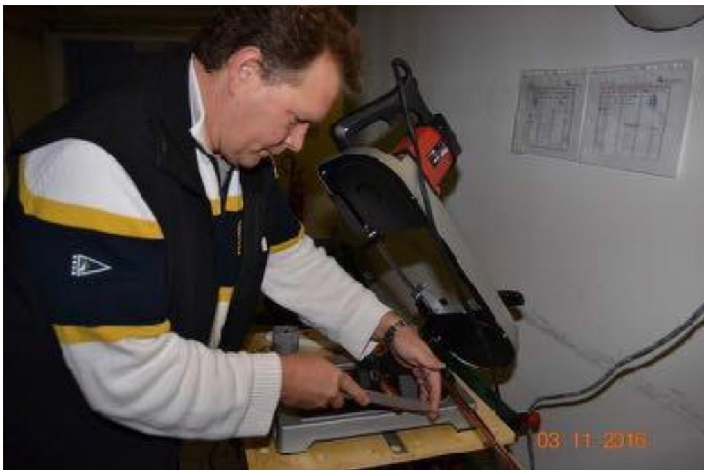
Bild 4: Entgraten der Rohrleitung: hier mit einer Feile
