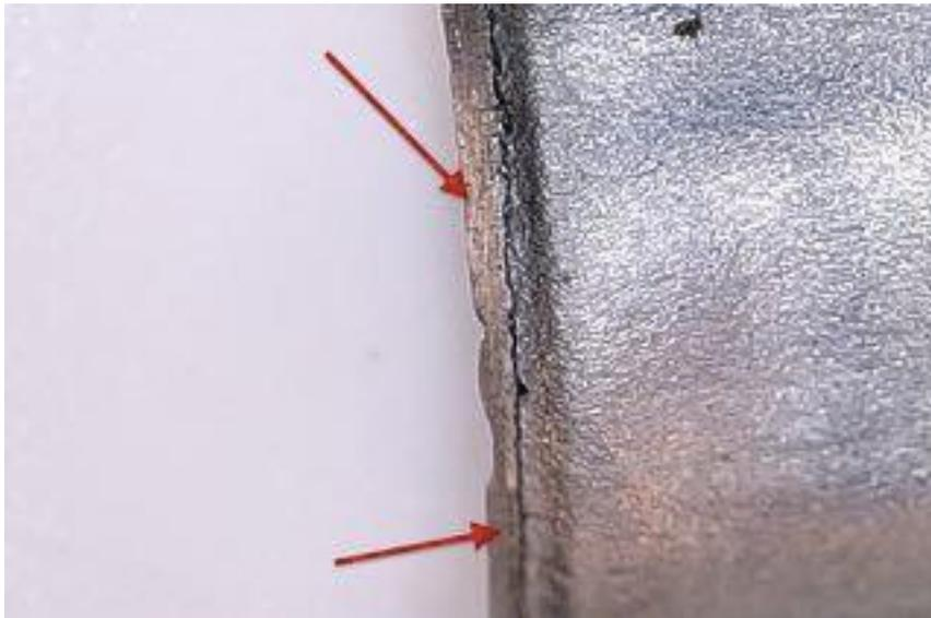
Bild 10: Edelstahlrohr; **nicht** fachgerecht ausgeführte Entgratung
