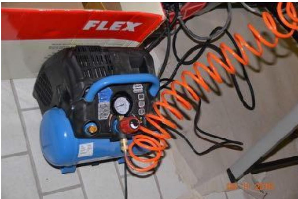
Bild 8: Bei Trinkwasserinstallationen ist eine Dichtheitsprüfung mit Luft nur mit ölfreier Luft oder Inertgas nach DIN EN 806-4 zulässig, ergänzt wird diese Norm durch die VDI/DVGW 6023 und dem ZVSHK Merkblatt "Dichtheitsprüfungen von Trinkwasser-Installationen mit Druckluft, Inertgas oder Wasser"
