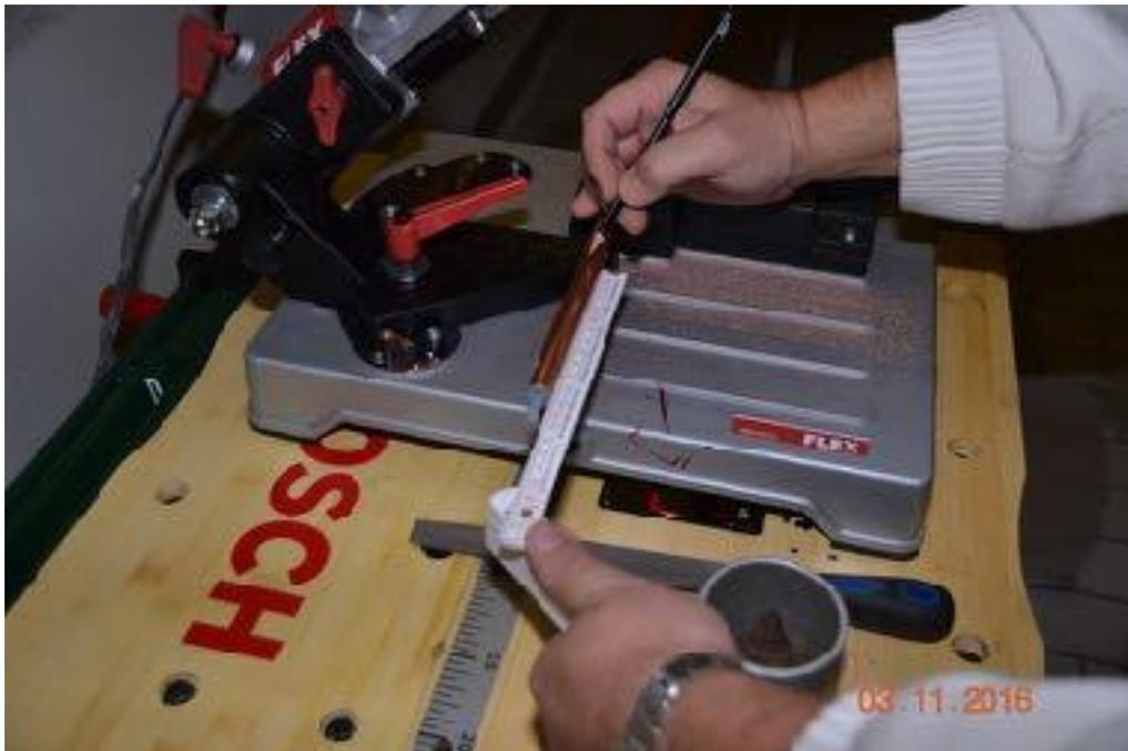
Bild 2: Anzeichnen des Sägeschnittes
