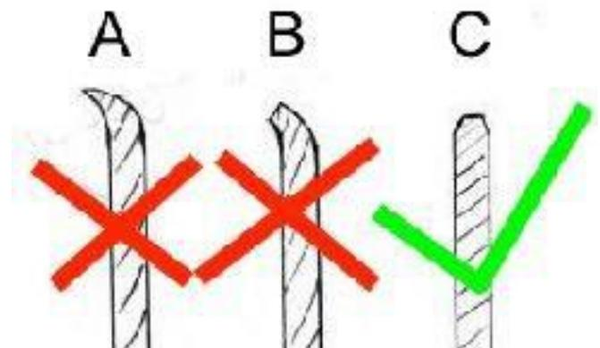
Zu den häufigsten Fehlern bei Rohrinstallationen gehört auch das falsche Ablängen. Doch die Qualität, Sicherheit und Festigkeit von Rohrverbindungen sind
