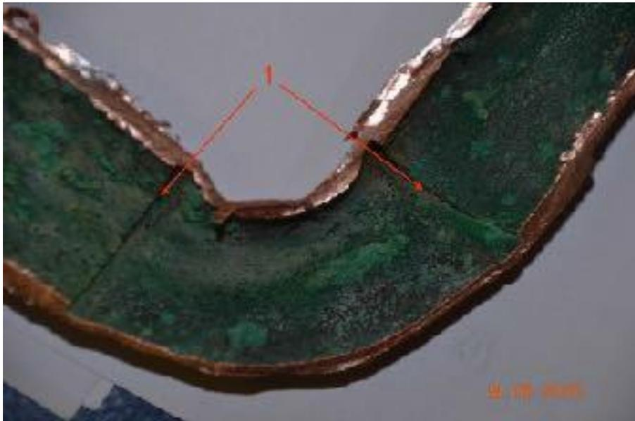
Bild 15: Längsschnitt einer Kupferverbindung 1 – Entgratung nicht fachgerecht
