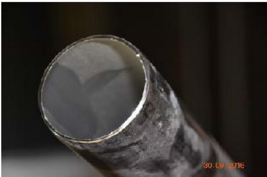
Bild 11: Edelstahlrohr; **nicht** fachgerecht ausgeführte Entgratung
